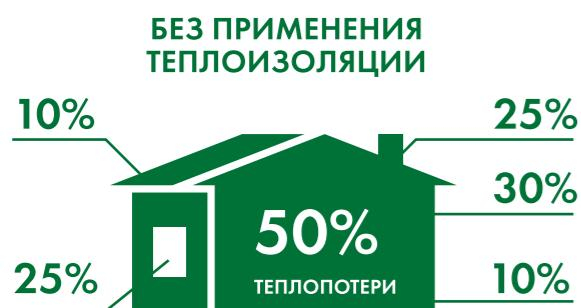
Теплопотери через ограждающие конструкции достигают 50%. Средний расход на отопление в год = 229 кВт • ч/м<sup>2</sup>.
